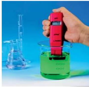
Le pH se mesure avec un papier pH ou un pH mètre.
