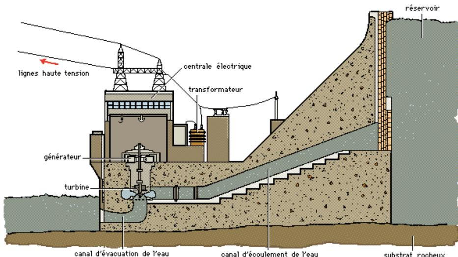
Sous l'effet de la gravitation (le poids), l'eau s'écoule d'amont en aval.
